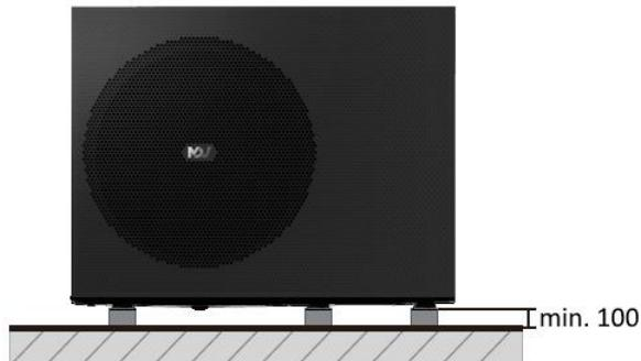
Hvis varmepumpen skal placeres under lukket overdækning, skal følgende afstande overholdes:
