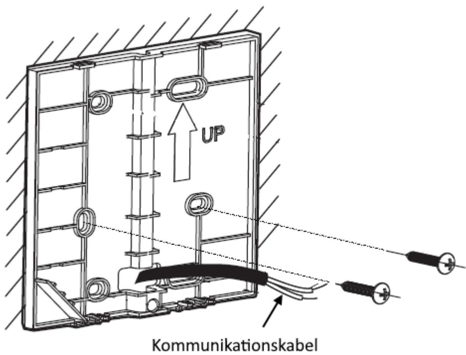
Kommunikationskablet trækkes gennem det firkantede hul i frontpanelet og tilsluttes i displayet – se 7.2.1.
