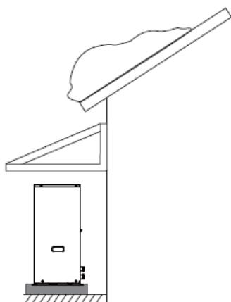
Det anbefales også at installere et tagudhæng over varmepumpen, for at forhindre slagregn og overløbene tagrender i at sende vand direkte på fordamperen, der under drift kan blive meget kold.
