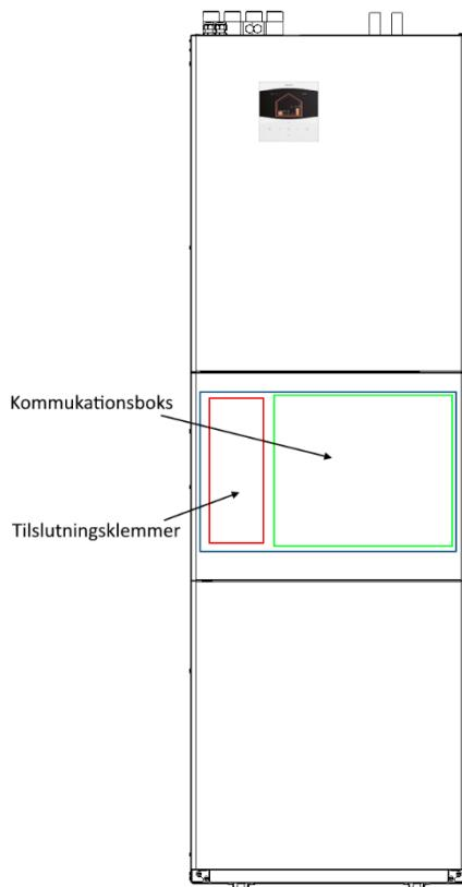
Tilslutningsboksen er placeret bag det midterste frontpanel.
