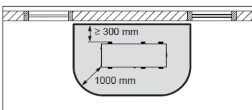
Placering af varmepumpen i et hjørne:
