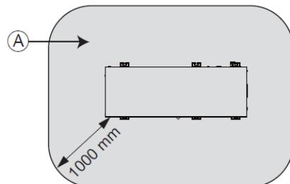
Placering af varmepumpen foran en væg:
