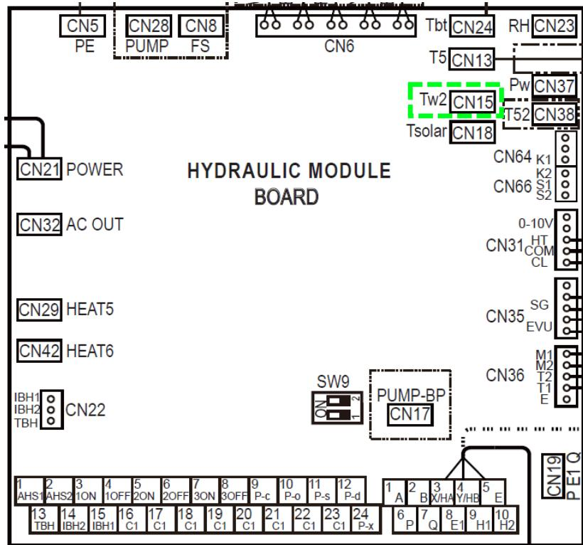
Fremløbsføleren monteres på fremløbsrøret efter mikserkredspumpen.
