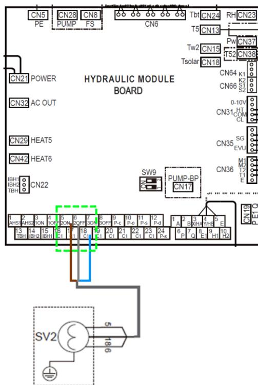
Mikserventilen (SV2) tilsluttes i kommunikationsboksen på terminalerne 5, 6 og 18 på klemrække CN11.
