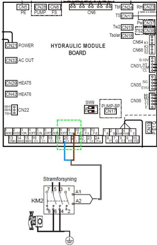
Mikserkredspumpen ( $P_c$ ) tilsluttes i kommunikationsmodulet på terminalerne 9 og 20 på klemrække CN11.
