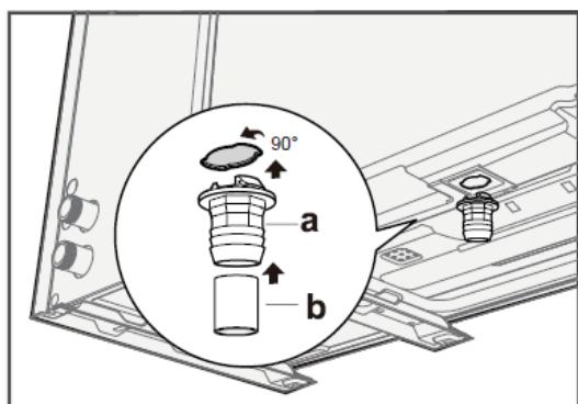
Den medleverede afløbsstuds (a) kan anvendes, og denne kobles med en passende afløbsslange til afløb.
