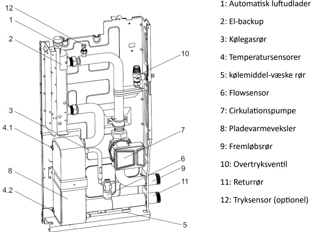
Det hydrauliske modul i varmepumpen sidder placeret bag ved varmepumpens styreboks.
