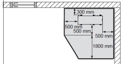
Sikkerhedszonen er minimum 500 mm højere end varmepumpen.
