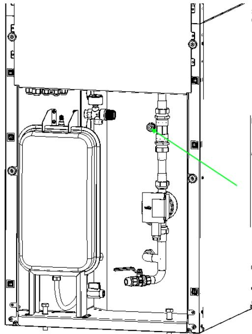
Elektrisk skal føleren tilsluttes i kommunikationsboksen på stikket CN13:
