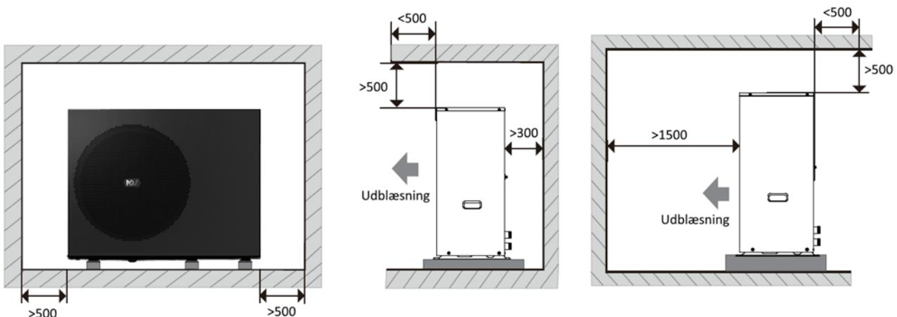
Hvis varmepumpen placeres i et indhak, skal følgende afstande overholdes:
