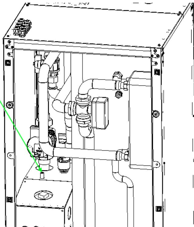
Elektrisk skal føleren tilsluttes i kommunikationsboksen på stikket CN24:
