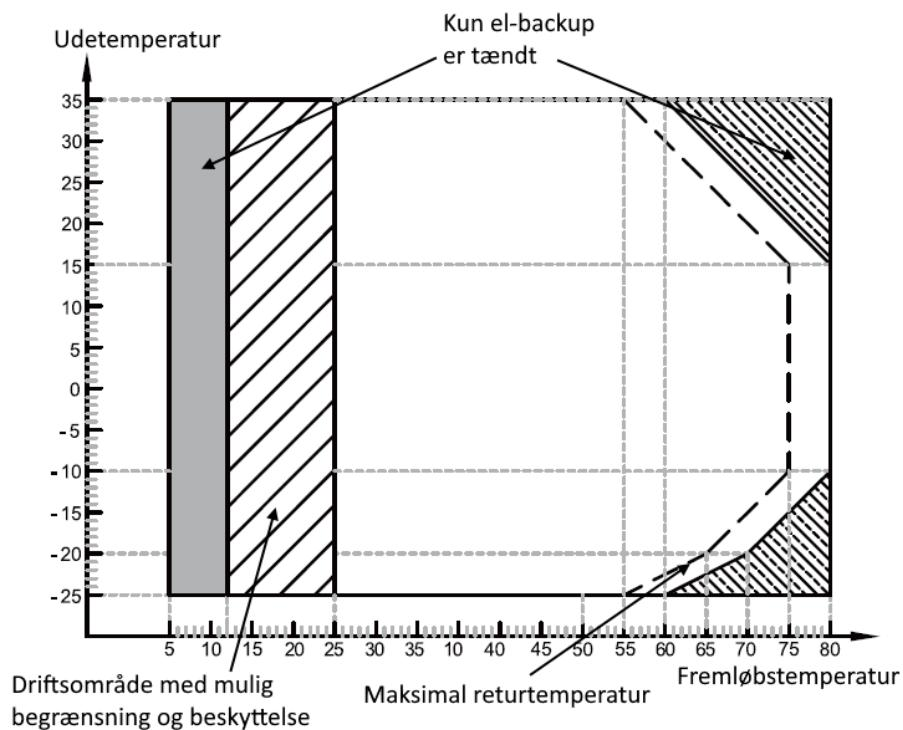
Ved varmtvandsproduktion er drift mulig ved en udetemperatur på mellem -25 til 46 °C.
