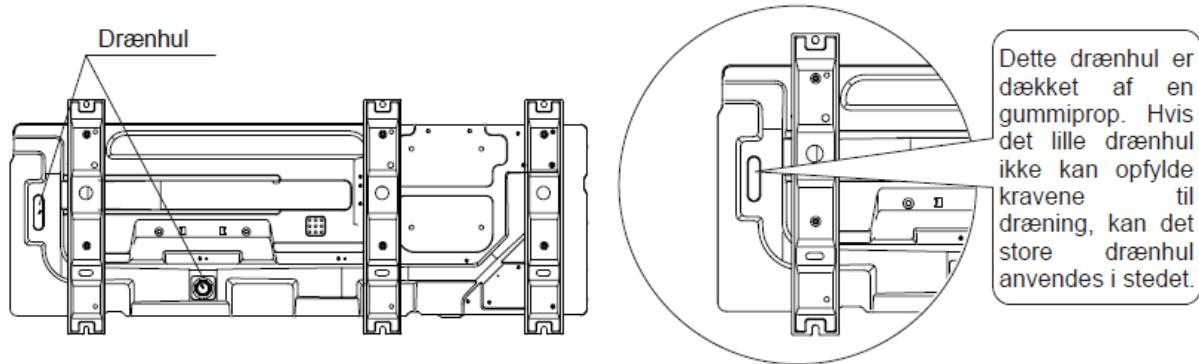
Varmepumpen danner en hel del kondens – især i kolde og fugtige perioder.
